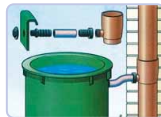
Zbieracz wody zainstalowany na rurze spustowej i podłączony do zbiornika naziemnego
