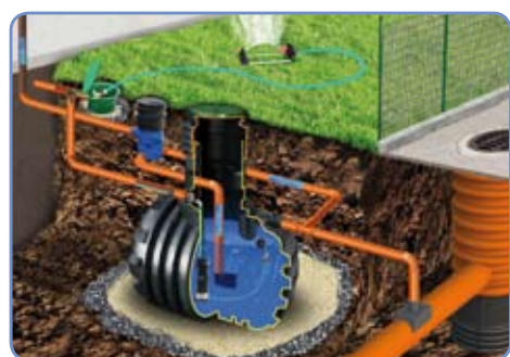
System GARDEN Complex II z przelewem do systemu kanalizacyjnego
